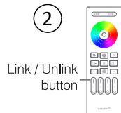
Короткое нажатие кнопки "I" 3 раза в течение 3 секунд при включении света
