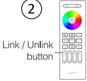
Короткое нажатие кнопки "I" 5 раз в течение 3 секунд при включении света
